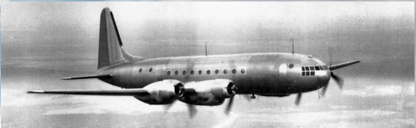
Первый поршневой Ил-18 в испытательном полете, 1946 год. Самолет был оснащен четырьмя поршневыми двигателями АШ-73.
